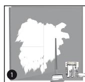
Стены должны иметь ровную поверхность. Не должно быть старых обоев. Чем ровнее стена, тем ровнее стыки и менее заметен заделанный шов. Стену рекомендуем прогрунтовать акриловым грунтом общего назначения (обычной строительной грунтовки глубокого проникновения), грунт дает защитную пленку и улучшает сцепление панели со стеной.
