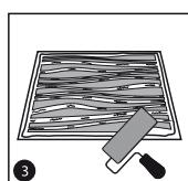
Нанесите «клей специальный Artpole» с помощью валика или шпателя на стену, затем нанесите клей на всю обратную сторону панели.
