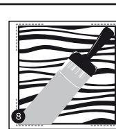
**Важно!!!** Даже при использовании рекомендованного клея возможно незначительное изменение линейных размеров панели. Как правило это является следствием несоблюдения основного требования — выдержать панели не менее 5 дней без полистиленовой упаковки в помещении до монтажа.
