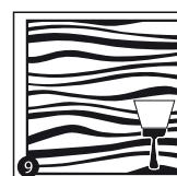
Обработайте неровности швов мелкой наждачной бумагой, стараясь не отходить от краев панели. Работу проводить до достижения требуемой гладкости поверхности шва. В процессе обработки шва мы рекомендуем применять подсветку для оценки результатов работы.
