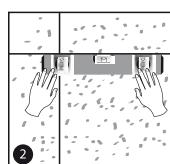
Разметьте поверхность с помощью уровня или отвеса. Определите общий контур композиции и ее место на стене. Произведите разметку стены вертикальными и горизонтальными линиями таким образом, чтобы получить «сетку-шаблон», которая поможет аккуратно наклеить панели на стену.
