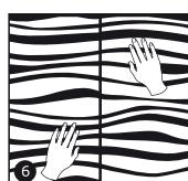
При приклеивании последующих панелей возможно небольшое их перемещение после соприкосновения со стеной (в течении 30-60 сек.) для стыковки рисунка. Время полного схватывания клея смотрите на упаковке. Для дополнительной временной фиксации панелей до полного
